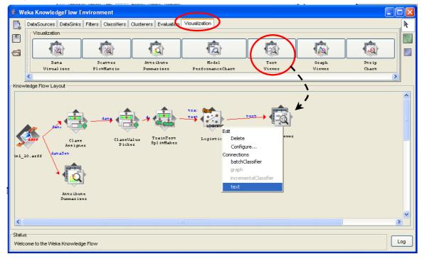
L'exécution de la chaîne de traitement s'effectue alors en activant le menu START LOADING du premier composant (ARFF LOADER). Le menu SHOW RESULTS du composant TEXTVIEWER permet d'afficher les résultats.
