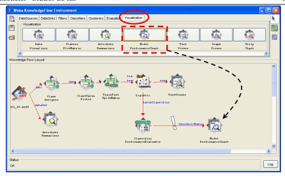
Il reste alors à relancer de nouveau l'exécution du diagramme (START LOADING de ARFF LOADER), puis visualiser les résultats en activant le menu SHOW PLOT du composant MODEL PERFORMANCE CHART. Une fenêtre apparaît, la courbe ROC est la courbe par défaut (le **taux de faux positifs** en abscisse et le **taux de vrais positifs** en ordonnée). Nous pouvons modifier le graphique en choisissant d'autres variables en abscisse et en ordonnée.
