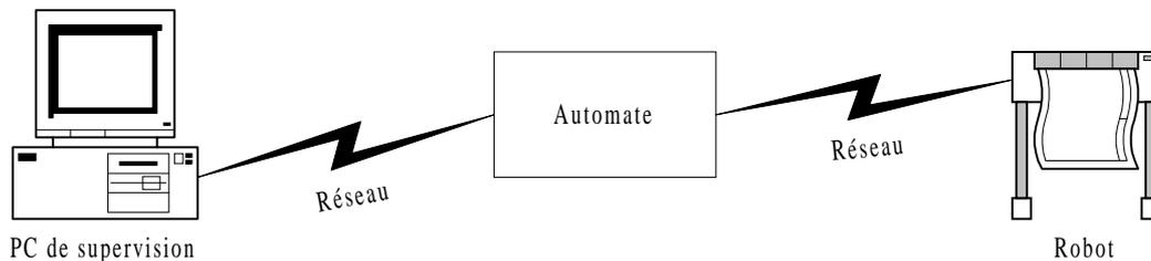
Le PC de supervision possède un algorithme qui permet de déterminer les  $N$  prochaines actions du robot ( $N$  est fixe). L'automate reçoit, via le réseau, les  $N$  prochaines actions du robot et les envoie une par une au robot, qui les exécute.
